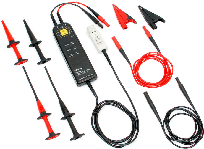
P52xxA 系列探头提供的高压差分测量解决方案适用于任何示波器。
