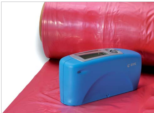
微型光泽仪45°：特别应用在陶瓷、塑料和薄膜的光泽测量。
